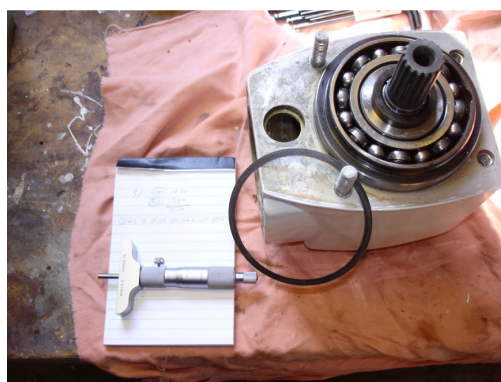
Kontroll av shimstjocklek mellan övre växellhus och mellanhus
